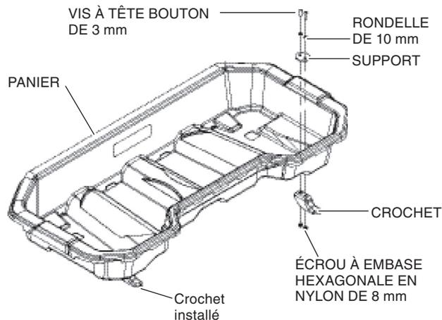
2. Soulevez le levier de chaque loquet Pro-Connect<sup>MC</sup> jusqu'à ce qu'il se déverrouille et glissez l'entretoise en caoutchouc autour du loquet Pro-Connect<sup>MC</sup>. Insérez le loquet Pro-Connect<sup>MC</sup> et l'ensemble d'entretoise dans le trou carré du panier et fixez solidement les loquets en installant un anneau élastique dans chaque loquet à partir du dessous de panier.
