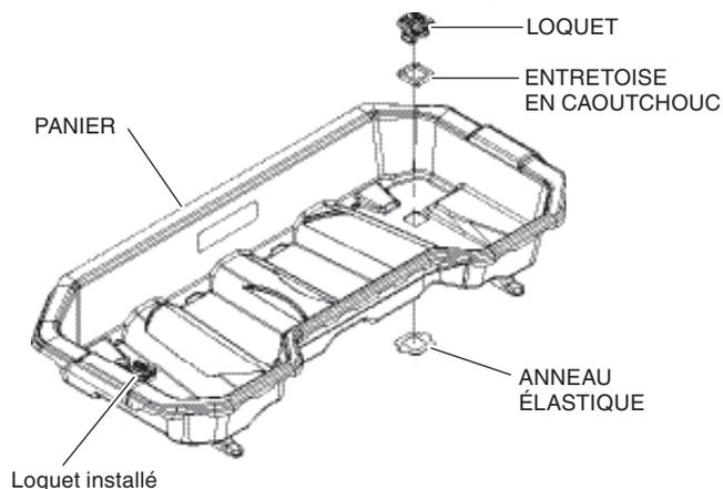
3. Soulevez le levier de chaque loquet jusqu'à ce qu'il se déverrouille. Placez le panier utilitaire sur le porte-bagages arrière du VTT. Alignez chaque loquet avec chaque orifice correspondant dans le porte-bagages, puis insérez chaque loquet dans son orifice.
