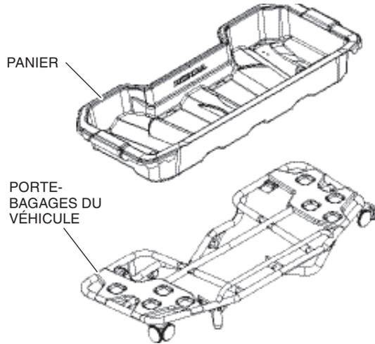
4. Fixez le bac de rangement au véhicule en abaissant le levier de chaque loquet Honda Pro-Connect<sup>MC</sup>.
